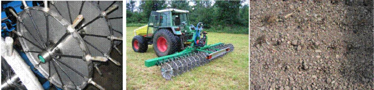
**Abbildung 48:** Ausbringung des Ammoniumsulfats aus der Ammoniakstrippung mittels dem CULTAN-Verfahren. Links ist das Injektorrad zu sehen. Mitte links im Einsatz mit einem Geräteträger. Der Düngertank befindet sich vorne auf dem Traktor. Mitte rechts ist die Ablage des Düngers im Ackerland zu erkennen.
