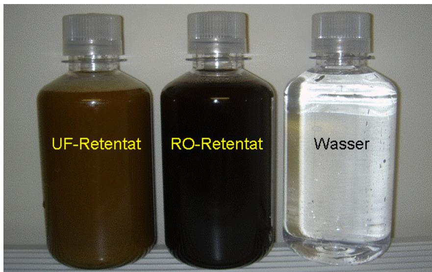
**Abbildung 50:** Endprodukte aus der Membrantrennung von Gülle / Gärreste. Links das UF-Retentat, in der Mitte das RO-Retentat und rechts das Brauchwasser.
